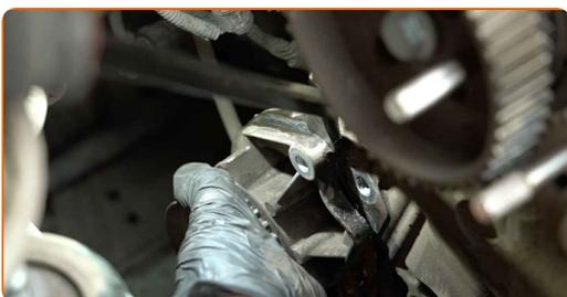
**54** Desenrosque os fixadores da bomba de água. Use HEX n.º H6. Use uma chave de catraca.
