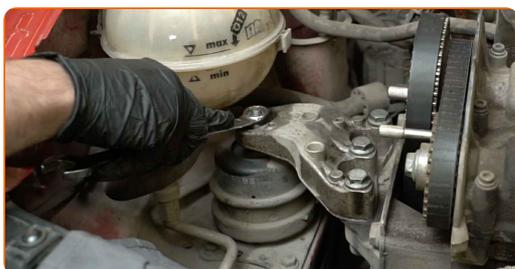
**33** Retire os parafusos de fixação.
