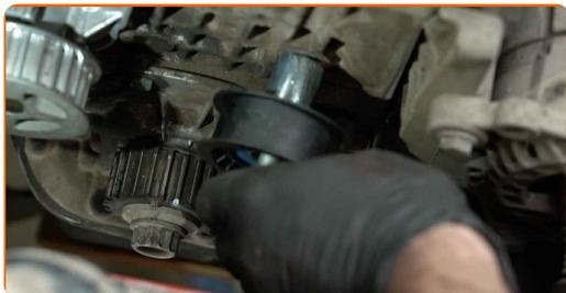
**69** Aperte o elemento fixador da polia de desvio da correia de distribuição. Use uma chave soquete nº 15. Use uma chave de torque. Aperte-o para o torque de 25 Nm.
