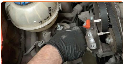
**35** Desaperte os fixadores de apoio do motor. Use uma chave soquete nº 16. Use uma chave de catraca.
