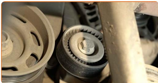
**19** Desaparafuse o fixador da polia de tensão da correia poly-V. Use uma chave combinada nº 16.
