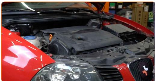
**4** Desenrosque os elementos de fixação dos terminais da bateria do carro. Use uma chave soquete nº 10. Use uma chave de catraca.
