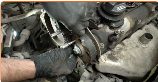
**52** Desaparafuse os fixadores da cobertura lateral da correia de distribuição. Use uma chave soquete nº 10. Use HEX n.º H6. Use uma chave de catraca.
