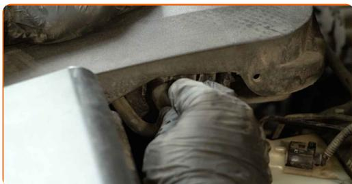
**109** Remova a tampa do depósito do líquido de refrigeração.
