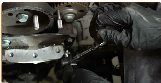
**36** Retire os parafusos de fixação.
