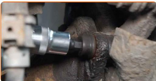
**15** Retire os parafusos de fixação.
