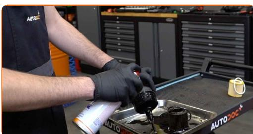
**20** Instale um novo anel O-ring no seu assento de montagem na tampa do filtro.
