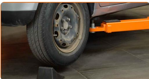
**4** Desaperte os parafusos da roda.
