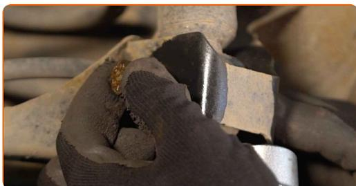
**10** Remova o apoio sob a viga do eixo traseiro.
