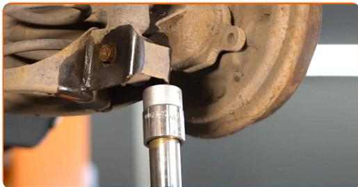
**9** Remova o parafuso de fixação.
