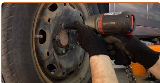
**22** Baixar o carro e trabalhar em ordem transversal, apertar os parafusos das rodas. Use o soquete de impacto para roda #17. Use uma chave de torque. Aperte-o para o torque de 120 Nm.
