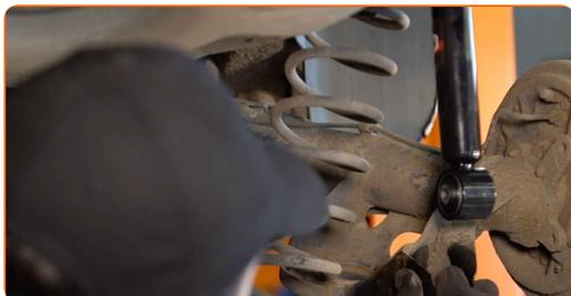
Substituição: molas de suspensão – SKODA Fabia II Hatchback (542).
