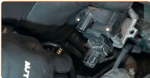
Substituição: bobina de ignição – SKODA FAVORIT (781). AUTODOC recomenda:
