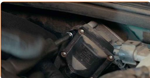
**4** Remova a bobina de ignição.
