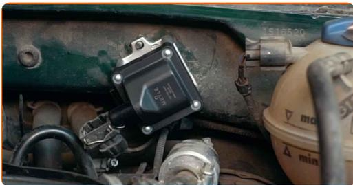
**10** Apertar a fixação da bobina de ignição. Use uma chave soquete nº 10. Use uma chave de torque. Aperte-o para o torque de 7 Nm.
