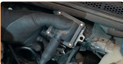
**5** Desconecte o cabo de alta tensão.
