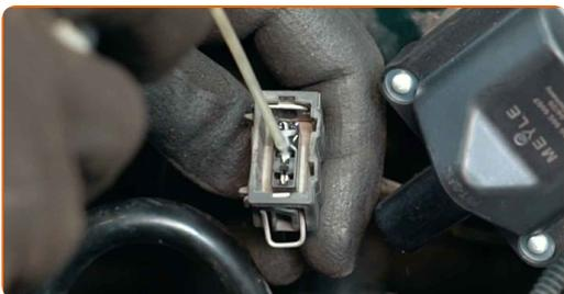
**12** Ligue o conector da bobina de ignição.
