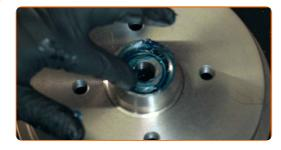
Trate do cubo de roda na área em que entra em contacto com o tambor de travão. Use um lubrificante multiusos.
