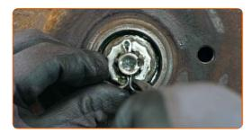
Desaparafuse a porca do cubo. Use uma chave soquete nº 24. Use uma chave de catraca.
