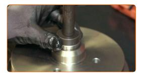
Trate o anel interior e o rolamento da roda. Use um lubrificante multiusos.
