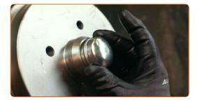
Limpe o local de montagem do aro do pneu. Use uma escova metálica.
