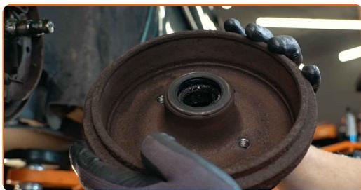
**13** Limpe o local de montagem do rolamento de cubo. Use o spray de limpeza universal.
