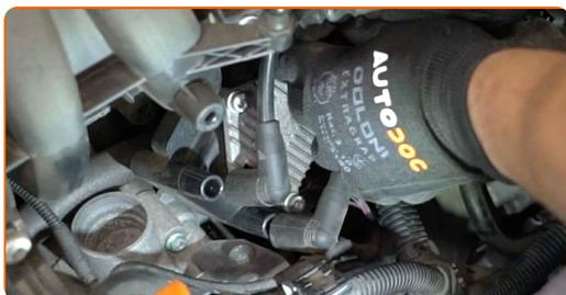
Substituição: bobina de ignição – SKODA OCTAVIA (1U2). AUTODOC recomenda:
