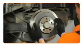
Aperte os fixadores do tambor de travão. Use Torx T30. Use uma chave de torque. Aperte-o para o torque de 4 Nm.
