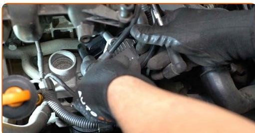
Substituição: bobina de ignição – SKODA Octavia I Combi (1U5). AUTODOC recomenda:
