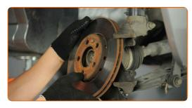
Desaperte a porca do eixo do cubo da roda. Use uma chave soquete nº 30. Use uma chave de catraca.
