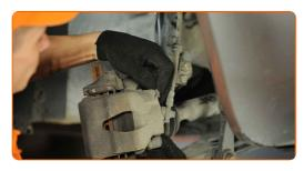
Trate os fixadores do amortecedor. Trate a porca de fixação conectada ao terminal de direção à manga de eixo.
