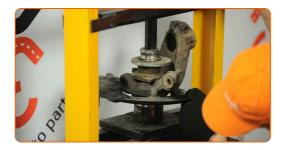
Substituição: rolamento da roda – SKODA Octavia I Combi (1U5). Conselho da AUTODOC:
