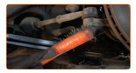
Desenrosque a extremidade da porca de fixação da manga de eixo. Use uma chave soquete nº 19. Use uma chave de catraca.
