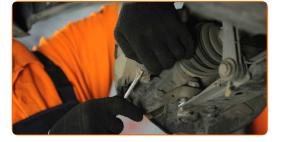
Desaparafuse a fixação de pinça de travão. Use HEX n.º H7. Use uma chave de catraca.
