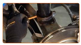
Aperte os fixadores inferiores do dispositivo amortecedor. Use uma chave combinada nº 18. Use uma chave soquete nº 18. Use uma chave de torque. Aperte-o para o torque de 60 Nm.+90°
