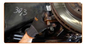
Aperte a porca de fixação conectada ao terminal de direção à manga de eixo. Use uma chave soquete nº 19. Use uma chave de torque. Aperte-o para o torque de 45 Nm.
