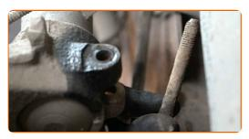
Desligar a manga de eixo do suporte do amortecedor. Use um martelo de borracha.
