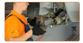
Fixe o suporte do amortecedor na manga de eixo. Use um martelo de borracha.
