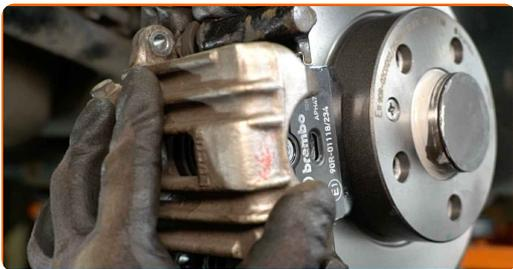
**45** Instale os parafusos de fixação.
