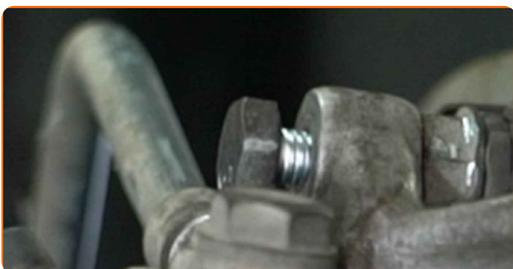
**46** Aperte os fixadores da pinça do travão. Use uma chave soquete nº 13. Use uma chave de torque. Aperte-o para o torque de 35 Nm.
