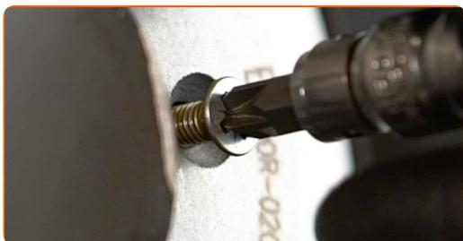
**37** Aperte os fixadores do disco de travão. Use a chave Phillips. Use uma chave de torque. Aperte-o para o torque de 4 Nm.
