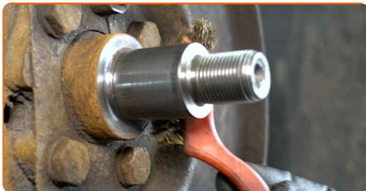
**28** Limpe o sensor de ABS. Utilize uma escova de limpeza de nylon. Use o spray de limpeza universal.
