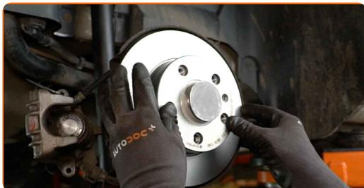
**36** Instale o parafuso de fixação.
