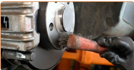
**48** Trate a superfície onde o disco de travão entra em contacto com o aro da roda. Utilize massa lubrificante de cerâmica.
