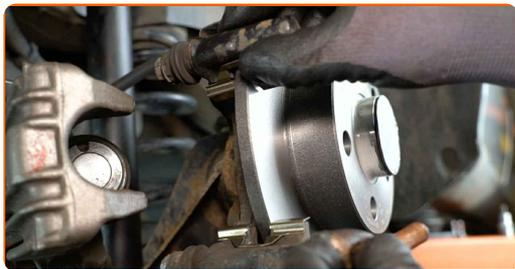
**40** Instale os parafusos de fixação.
