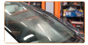
Puxe a alavanca do limpa para-brisas para a posição inferior. Ao fazer isso, irá mudar os limpa para-brisas do modo de serviço para o modo de operação.
