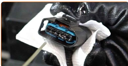
**14** Junte o conector do sensor de fluxo de massa de ar.
