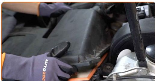
**12** Aparafusar os parafusos de fixação da tampa do filtro de ar. Use a chave Phillips.
