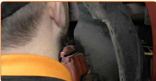
**14** Instale e aperte os elementos de fixação da cobertura do arco da roda. Use Torx T25.
