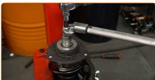
**Substituição: cabeçotes do amortecedores – SKODA Octavia II Combi (1Z5).**
