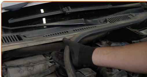
**4** Limpe os fixadores do painel dianteiro do limpador-parabrisas. Use uma escova metálica. Use spray WD-40.
