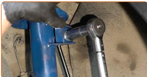
**13** Aperte o fixador que conecta a bieleta da barra estabilizadora à barra estabilizadora. Use uma chave soquete nº 18. Use uma chave de torque. Aperte-o para o torque de 60 Nm.
