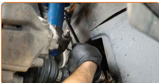
**12** Desaparafuse o fixador que conecta bieleta da barra estabilizadora à barra estabilizadora. Use uma chave soquete nº 18. Use uma chave de torque. Aperte-o para o torque de 60 Nm.
