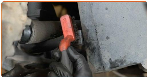
**11** Instale uma nova barra, aperte os parafusos de fixação. Use uma chave combinada nº 18. Use uma chave soquete nº 18. Use HEX n.º H5. Use uma chave de catraca.
