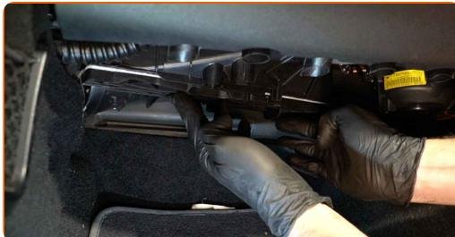
**8** Voltar a montar o revestimento inferior.
