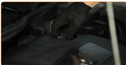
**22** Ligue o motor por alguns minutos. Após a luz de advertência da pressão do óleo se apagar, desligue o motor.
