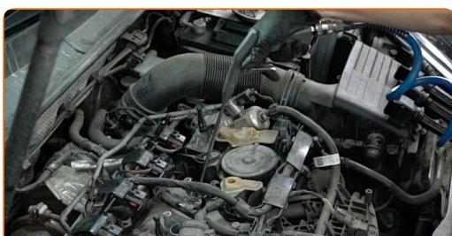
9 Desaperte as velas de ignição. Use o soquete da vela de ignição #16. Use uma chave de catraca.
