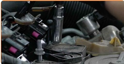
6 Retire os parafusos de fixação.
