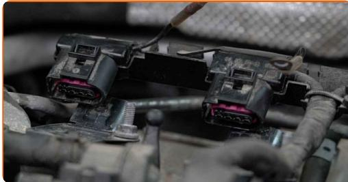
5 Desaperte os fixadores das bobinas de ignição. Use uma chave soquete nº 10. Use uma chave de catraca.
