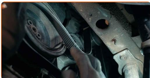
**Substituição: correia trapezoidal estriada – SKODA Rapid Hatchback (NH3).
