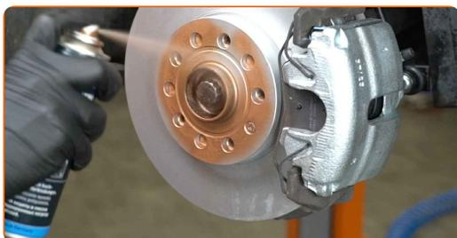
**22** Limpe a superfície do disco de travão. Utilize um produto de limpeza para travões.
