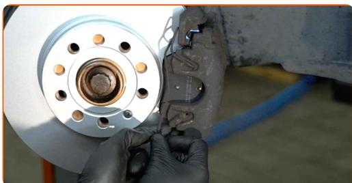
**21** Trate a superfície onde o disco de travão entra em contacto com o aro da roda. Use massa de cobre.
