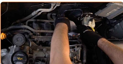
**5** Desaperte as abas de bloqueio plásticas do conector da bobina de ignição. Use uma chave de fenda plana.
