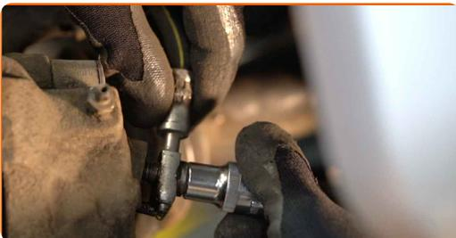
**12** Desaperte o elemento de fixação que liga a mangueira do travão ao tubo do circuito de travagem. Use uma chave combinada nº 11.
