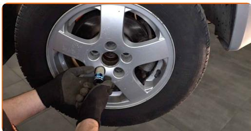
29 Baixar o carro e trabalhar em ordem transversal, apertar os parafusos das rodas. Use uma chave de torque. Aperte-o para o torque de 120 Nm.
