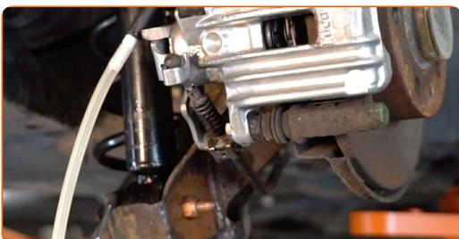
**27** Prenda o cabo do travão de estacionamento com o clipe de retenção.
