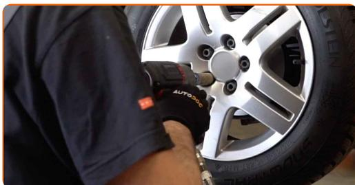
**37** Baixar o carro e trabalhar em ordem transversal, apertar os parafusos das rodas. Use uma chave de torque. Aperte-o para o torque de 120 Nm.
