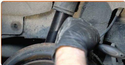
**40** Instale o parafuso de fixação.
