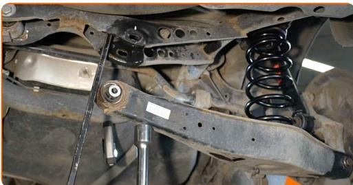
**46** Instale o parafuso de fixação.
