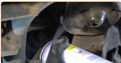
**43** Instale o compressor de mola em conjunto com os suportes de borracha nos locais de montagem.
