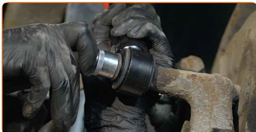
**42** Limpe os locais de montagem da mola espiral. Use uma escova metálica. Use spray WD-40.
