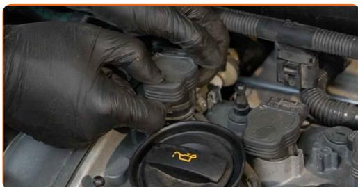
**Substituição: vela de ignição – SKODA SUPERB (3T4). Conselho:**
