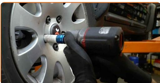
**33** Baixar o carro e trabalhar em ordem transversal, apertar os parafusos das rodas. Use o soquete de impacto para roda #17. Use uma chave de torque. Aperte-o para o torque de 120 Nm.
