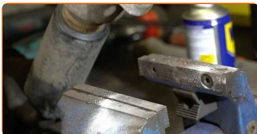
**21** Limpe os locais de montagem do amortecedor. Use uma escova metálica. Use spray WD-40.
