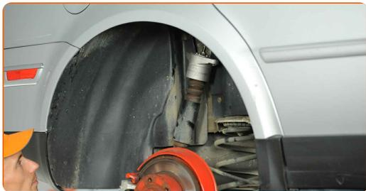
Substituição: cabeçotes do amortecedores – SKODA SUPERB (3U4).
