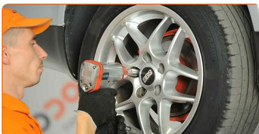
**31** Baixar o carro e trabalhar em ordem transversal, apertar os parafusos das rodas. Use uma chave de torque. Aperte-o para o torque de 120 Nm.
