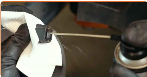
**11** Limpe o assento de montagem do sensor de ABS. Use uma escova metálica. Use spray WD-40.
