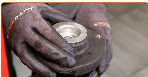
**50** Aperte a porca do suporte do amortecedor da haste do pistão. Chave para a porca do amortecedor de 21 mm. Use HEX n.º H6. Use uma chave de torque. Aperte-o para o torque de 60 Nm.
