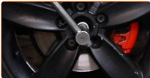
**11** Solte os parafusos de montagem das rodas. Use o soquete de impacto para roda #17.
