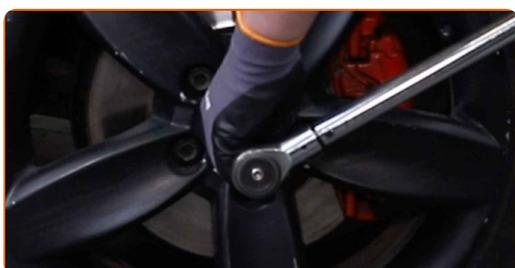
**86** Apertar os parafusos da roda usando um padrão cruzado. Use o soquete de impacto para roda #17. Use uma chave de torque. Aperte-o para o torque de 120 Nm.
