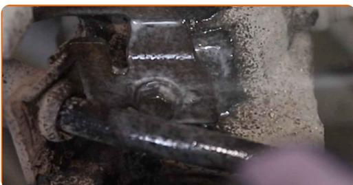
**20** Desparafuse o fixador que liga o suporte da mangueira do travão à torre da suspensão. Use uma chave combinada nº 10.
