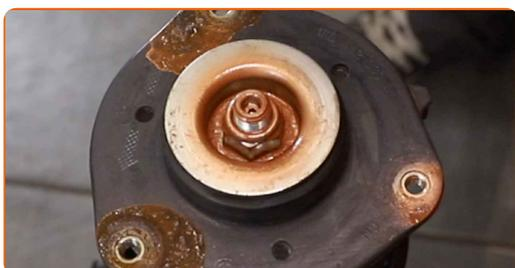
**53** Retire a coluna de suspensão montada.
