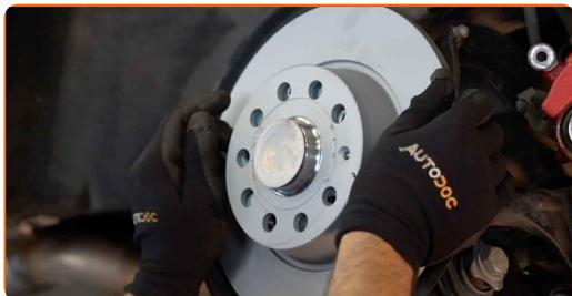
**24** Aperte a fixação do disco de travão. Use Torx T30. Use uma chave de torque. Aperte-o para o torque de 4 Nm.
