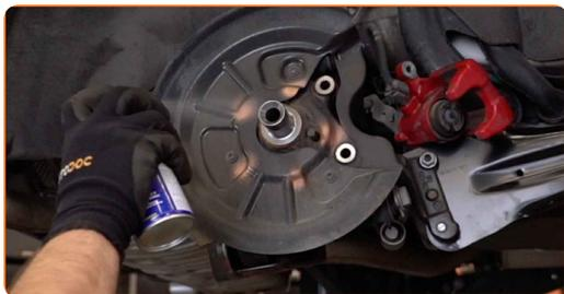
**19** Instale o novo cubo da roda com um rolamento.
