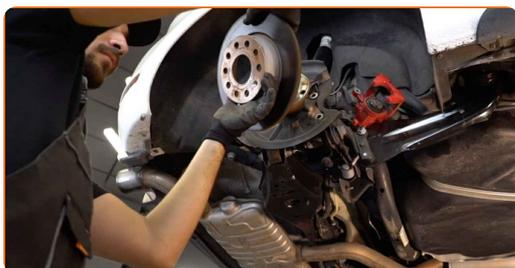
**15** Retire a tampa de proteção de rolamento de cubo. Utilize um pé-de-cabra. Use um martelo de borracha.
