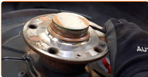
**16** Desaperte a porca do eixo do cubo da roda. Use XZN #18. Use uma chave de tarraxa.
