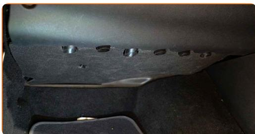
**9** Enroscar os elementos de fixação do revestimento inferior.
