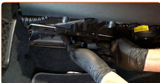
**8** Voltar a montar o revestimento inferior.
