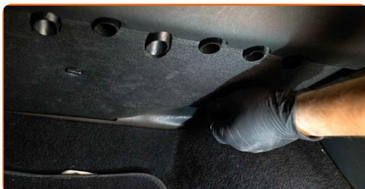
3 Desmontar o revestimento inferior.
