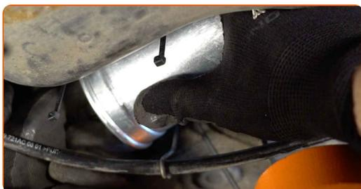
**11** Ligue os elementos de fixação do filtro de combustível. Use um alicate de corte.
