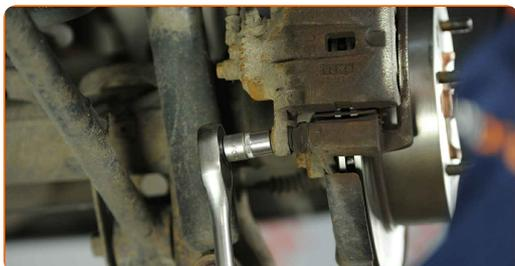
**9** Retire os parafusos de fixação (2 peças).
