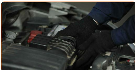
**27** Apertar os parafusos de fixação da caixa do filtro. Use uma chave soquete nº 10. Use uma chave de catraca.
