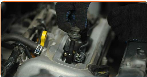
Substituição: vela de ignição – SUZUKI IGNIS II. Conselho de especialistas da AUTODOC:
