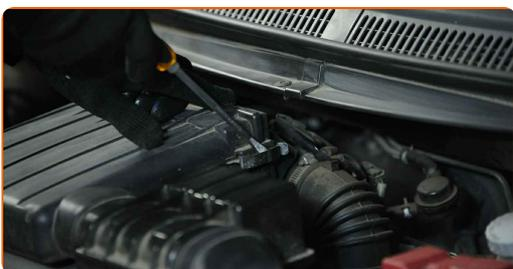
**4** Desapertar o fixador da caixa do filtro de ar. Use uma chave soquete nº 10. Use uma chave de catraca.
