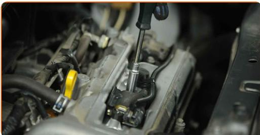
**11** Desconecte os conectores das bobinas de ignição. Use uma chave de fenda plana.
