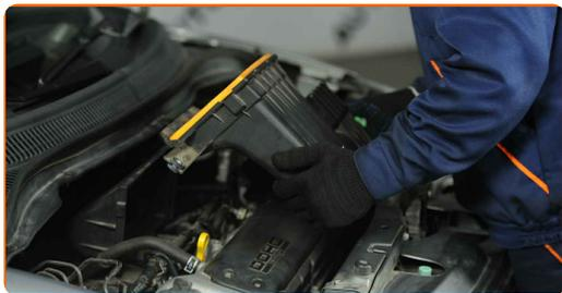
**26** Conecte o tubo de entrada de ar ao compartimento do filtro de ar.
