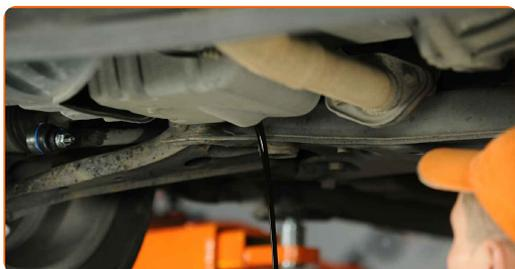
Substituição: óleo do motor e filtro – SUZUKI Samurai SUV (SJ\_). Conselho:
