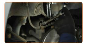
Remova o apoio do suporte do amortecedor.
