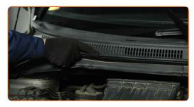
Instale os fixadores da carenagem da grelha de plástico do limpa para-brisas.
