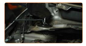
Instale a tampa protetora do suporte do amortecedor.
