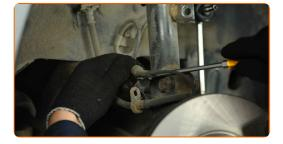
Limpe os fixadores que conectam as colunas de suspensão às mangas de eixo. Use uma escova metálica. Use spray WD-40.
