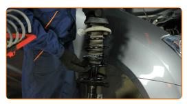
Aparafuse a fixação superior de montagem do suporte do amortecedor.
