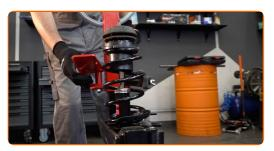
Aperte a porca do suporte do amortecedor da haste do pistão. Use uma chave combinada nº 19. Use HEX n.º H6. Use uma chave de torque. Aperte-o para o torque de 50 Nm.
