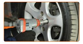
Baixar o carro e trabalhar em ordem transversal, apertar os parafusos das rodas. Use o soquete de impacto para roda #21. Use uma chave de torque. Aperte-o para o torque de 85 Nm.
