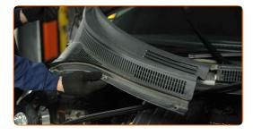
Remova a tampa protetora do suporte do amortecedor.
