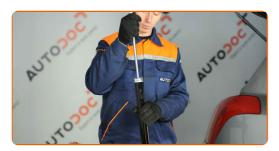
Instalar o suporte superior no novo amortecedor e fixá-lo em conformidade.
