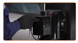
Apoie a ponta de eixo. Use um macaco hidráulico de caixa de transmissão.
