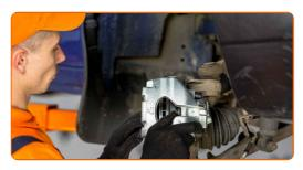
Coloque os pinos guia. Use HEX n.º H7. Use uma chave de torque. Aperte-o para o torque de 35 Nm.
