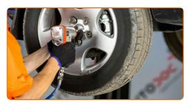
Baixar o carro e trabalhar em ordem transversal, apertar os parafusos das rodas. Use uma chave de torque. Aperte-o para o torque de 160 Nm.
