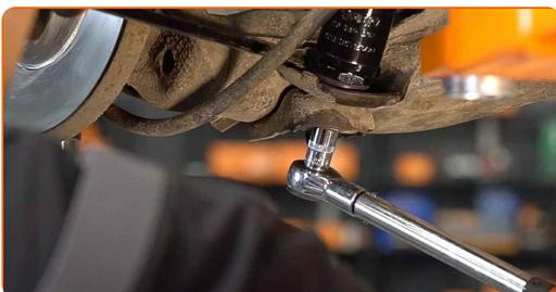
**19** Apertar a fixação superior do amortecedor. Use uma chave soquete nº 21. Use uma chave de torque. Aperte-o para o torque de 100 Nm.
