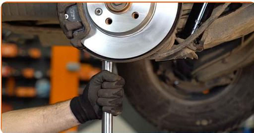
18 Aperte a fixação inferior do amortecedor. Use uma chave soquete n° 17. Use uma chave de torque. Aperte-o para o torque de 45 Nm.
