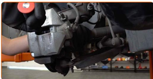
**9** Desconecte o sensor do indicador de desgaste das pastilhas de travão. Retire o conector do sensor de desgaste da pastilha de travão.
