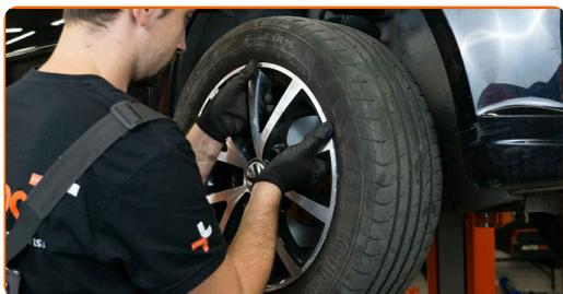
Substituição: discos de travão – VW Touran 1T3. Conselho da AUTODOC:
