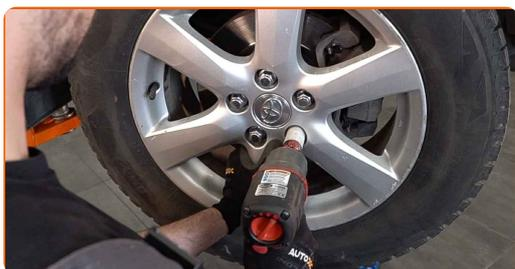
**17** Baixar o carro e trabalhar em ordem transversal, apertar os parafusos das rodas. Use o soquete de impacto para roda #21. Use uma chave de torque. Aperte-o para o torque de 103 Nm.
