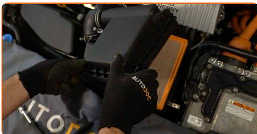
**6** Remova o elemento de filtro a partir da caixa do filtro.
