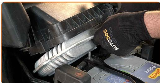
**6** Desaperte a braçadeira e os fixadores no tubo de entrada de ar do filtro de ar. Use uma chave soquete n° 10. Use uma chave de catraca.
