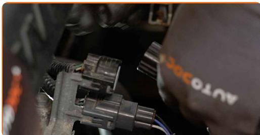
**4** Desaperte a braçadeira para soltar a cablagem da sonda lambda. Use uma chave de fenda plana.
