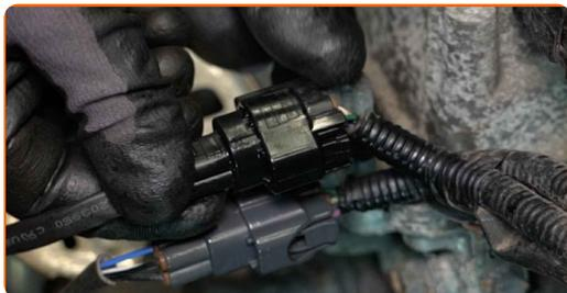
**25** Aperte a cablagem da sonda lambda com a braçadeira.
