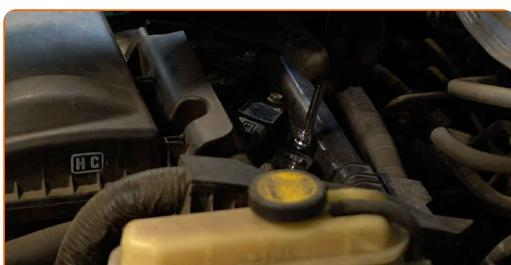
13 Retire as bobinas de ignição dos poços das velas de ignição.
