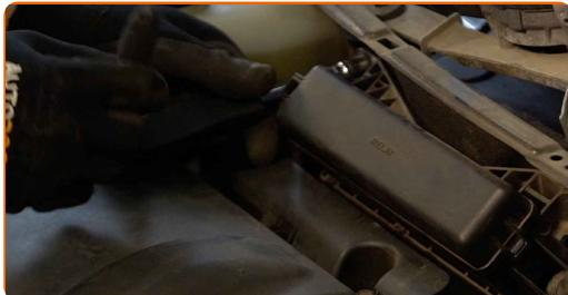
10 Remova o painel montado com a ligação das escovas do limpador-parabrisas.
