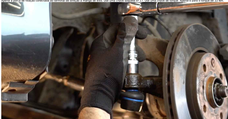
19 Apertar a porca de bloqueio do terminal de direção. Use uma chave combinada nº 17. Use uma chave combinada nº 19. Use uma chave de torque. Aperte-o para o torque de 47 Nm.
