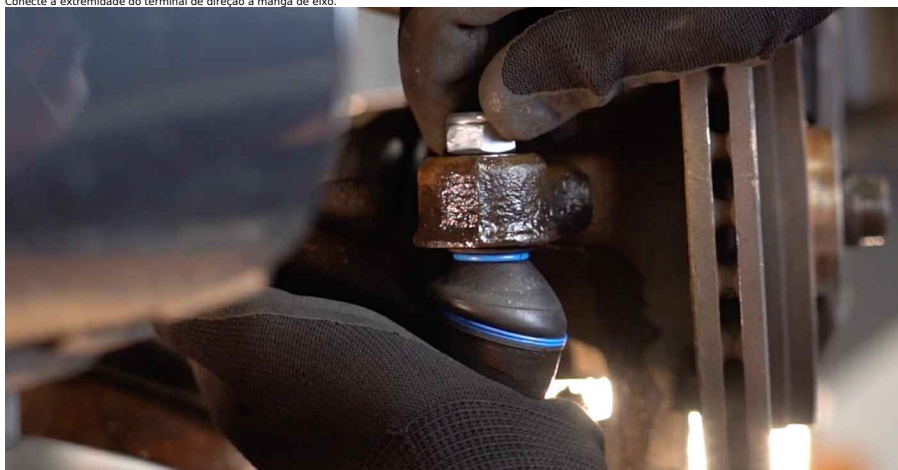
18 Aperte a porca de fixação conectada ao terminal de direção à manga de eixo. Use uma chave soquete nº 17. Use uma chave de torque. Aperte-o para o torque de 33 Nm.
