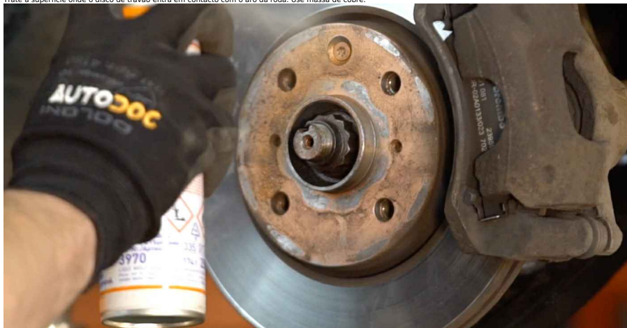
23 Limpe o local de montagem do aro do pneu. Utilize um produto de limpeza para travões.
