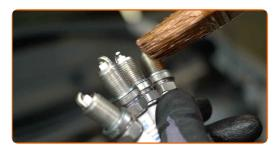
21 Instale as velas de ignição novas nos seus locais de montagem.
