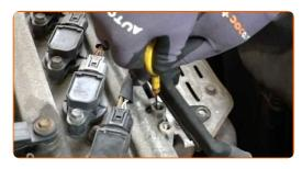
Desconecte os conectores das bobinas de ignição.
