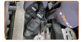
Desaperte os fixadores das bobinas de ignição. Use uma chave soquete nº 10. Use uma chave de catraca.
