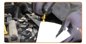
Volte a montar o suporte da cablagem.
