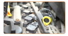
Desenrosque os parafusos do suporte da cablagem. Use uma chave soquete nº 10. Use uma chave de catraca.
