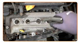
Desaperte as velas de ignição. Use o soquete da vela de ignição #16. Use uma chave de catraca.
