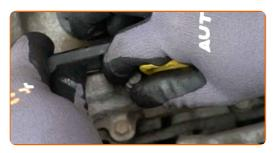
Aperte os parafusos do suporte da cablagem. Use uma chave soquete nº 10. Use uma chave de torque. Aperte-o para o torque de 9 Nm.
