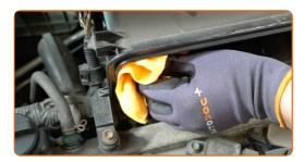
Limpe as bobinas de ignição.
