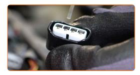
Ligue os conectores das bobinas de ignição.
